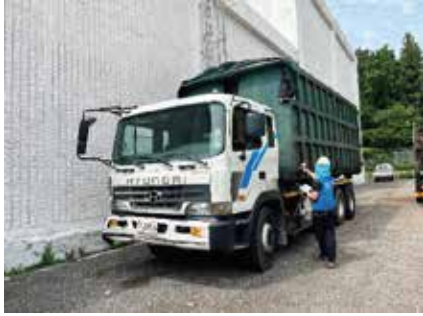
상차 후 차량 선량 측정 확인
